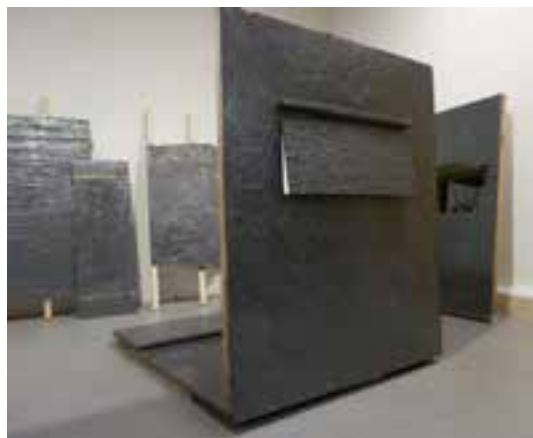
Hochstand Teile: restauriert und beschichtet mit radarabschirmendem Material
